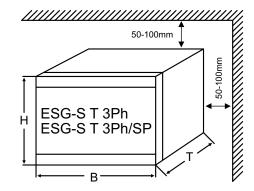
Das Gehäusegerät nach IP 54 kann an Einsatzorten montiert werden, die vor Staub und Feuchtigkeit nicht geschützt sind.
